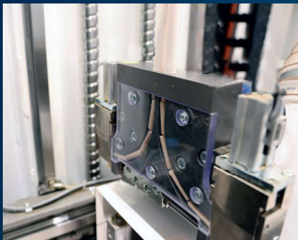
Típliző aggregát 2 kamrával, 8 mm átmérőjű és 30, 35 vagy 40 mm hosszú típlikhez.
