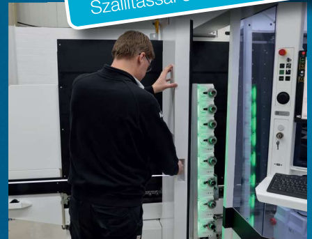
Integrált, 8 helyes lineáris szerszámváltó – a kezelőpult irányába nyílik, így kényelmesen hozzáférhető. Lehetővé teszi a szerszámok könnyű elérését.
